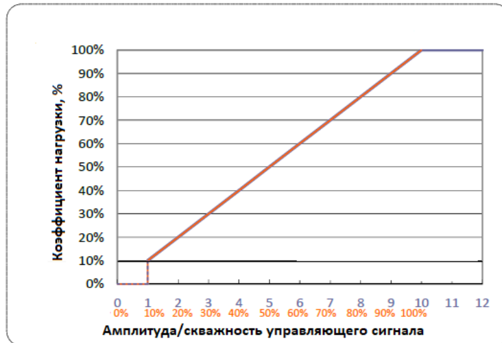
График зависимости мощности от уровня/скважности управляющего сигнала
