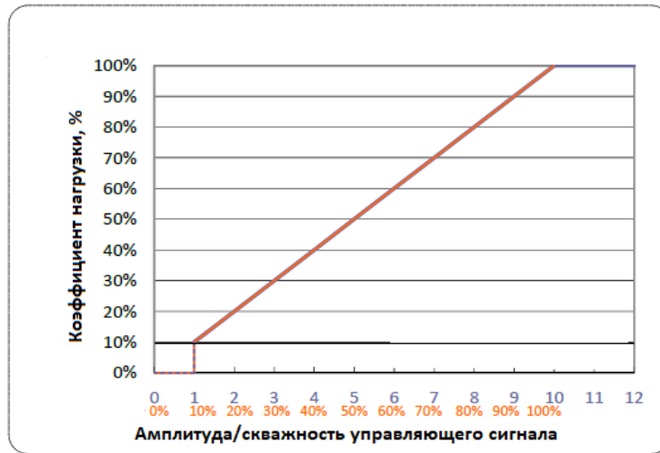
График зависимости мощности от уровня/скважности управляющего сигнала
