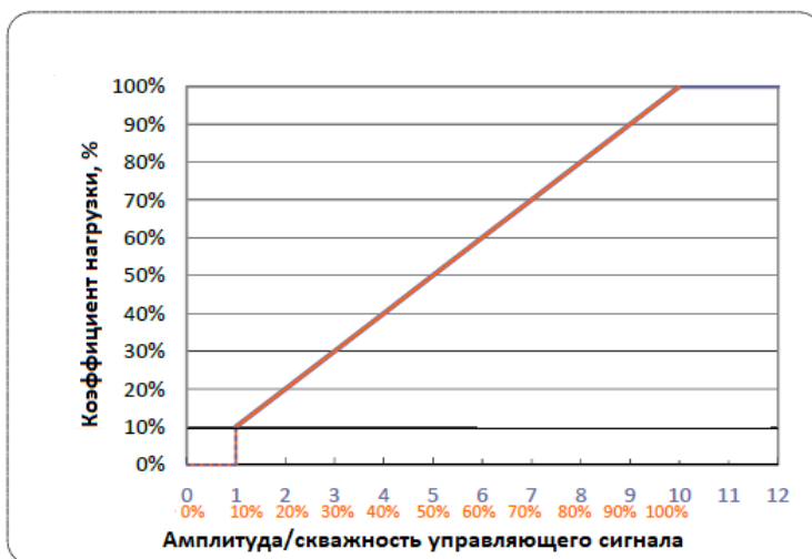
График зависимости мощности от уровня/скважности управляющего сигнала
