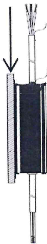
Неправильная установка светодиодного драйвера
